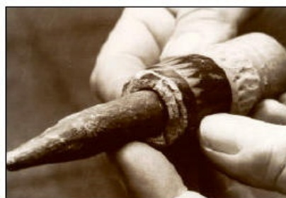
Fig.68 - Un proiettile anticarro ad elevata penetrazione contenente al suo interno uranio impoverito
